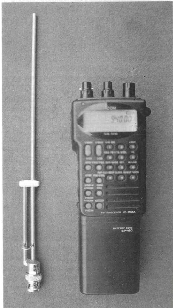
L'IC-W2 e l'antenna J a 3/4 \lambda citata in questo articolo.
