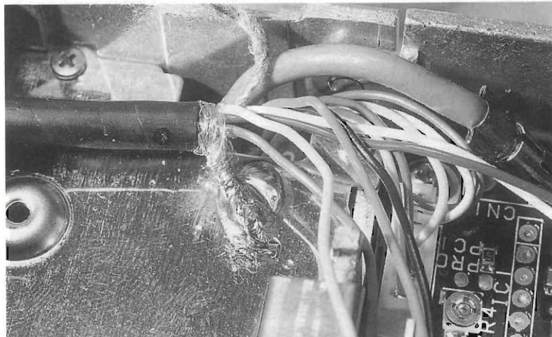
figura 4 - Particolare dell'ancoraggio del cavo schermato multipolare per il collegamento del TM731 con il modem.
