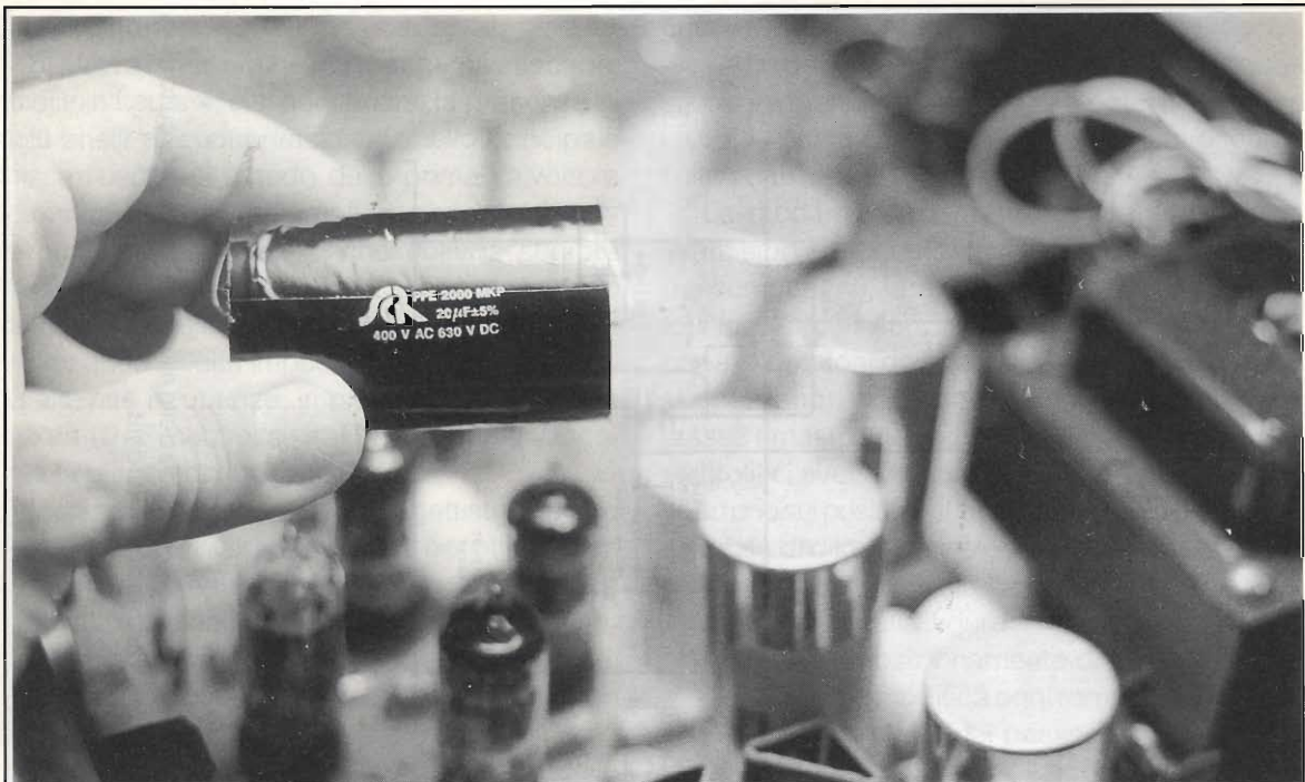
figura 6 - Vista ravvicinata di un condensatore "Solen" da 20\mu\text{F}/400\text{Vac} , 630\text{Vdc} . Sullo sfondo i condensatori elettrolitici della Sprague ancora da "estirpare".
